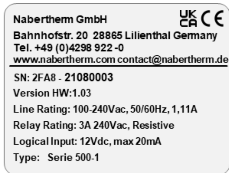
Fig. 7: Eksempel (typeskilt på betjeningsenhet)
