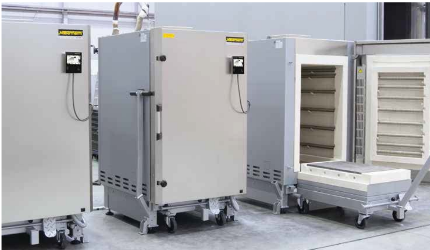
Kammerovne med udtrækbare vogne til ergonomisk påfyldning af brændkammeret
