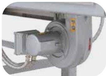
Køleblæser til ovne op til 300 liter reducerer procestiderne
