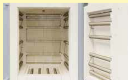
Opvarmning fra fem sider og specielt placering af varmelegemer for en optimal ensartet temperatur
